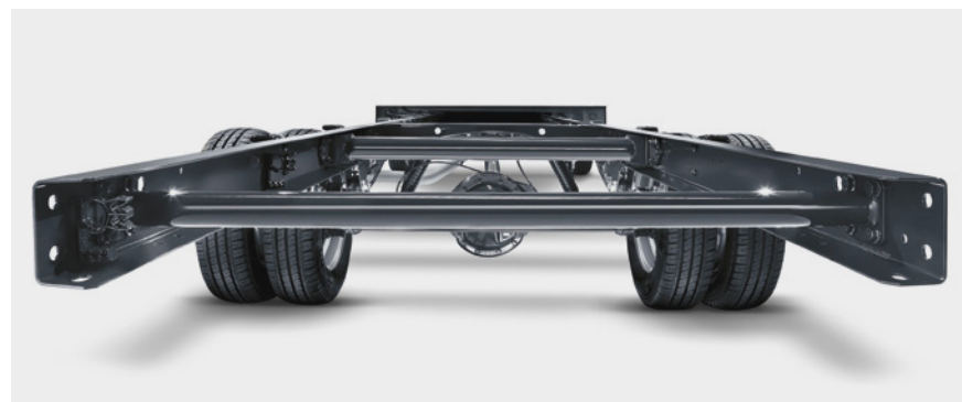
Det ekstra stærke QUAD-TOR-ophæng giver mulighed for nyttelaster op til 4900 kg. Muligt som option.
