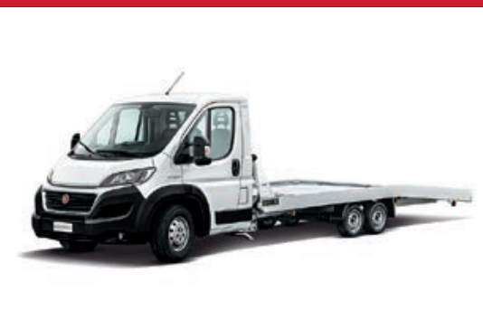
Opbygning som autotransporter Alko chassis ramme med dobbelt bagaksel.
